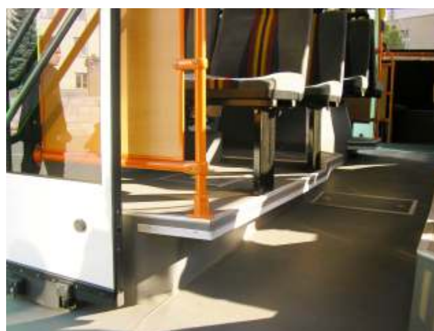
Отопление в салоне северного исполнения
