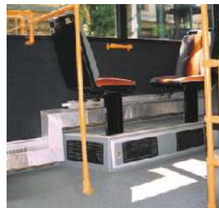
Отопление в салоне северного исполнения
